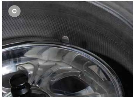
**D-E-F.** Posizionando l'utensile di montaggio del REVOLVER tra cerchio e pneumatico, automaticamente il RULLO IN PLASTICA del REVOLVER aiuterà lo pneumatico a rimanere nel canale.
