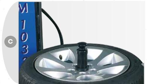
**BLOCCAGGIO RUOTA RILASCIANDO IL PEDALE**
