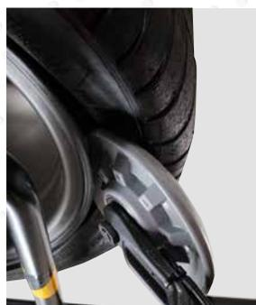
Successivamente, il disco stallonatore inferiore preme da sotto e la contemporanea rotazione della ruota **facilita la stallonatura inferiore**.
