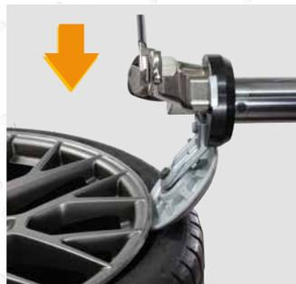
Il disco stallonatore del revolver **preme idraulicamente** sullo pneumatico e la contemporanea rotazione della ruota facilita la stallonatura superiore.
