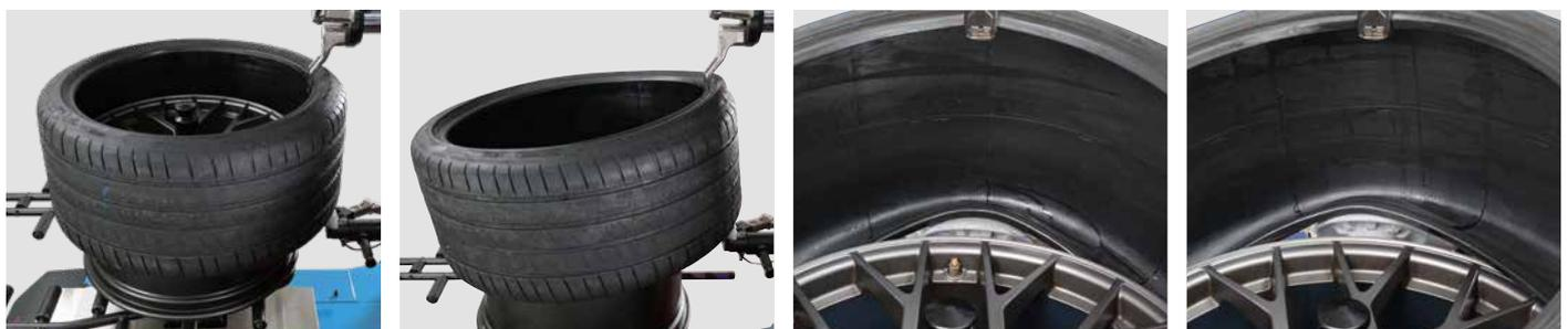
Continuando la sua corsa a salire, con il **movimento sincronizzato** della ruota, il solo disco stallonatore completa lo smontaggio dello pneumatico
