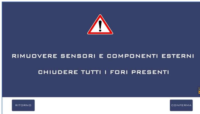
**NOTA BENE:** prima di iniziare la fase di lavaggio è necessario provvedere alla rimozione di ogni eventuale sensore o componente aggiuntivo esterno presente nel DPF ed alla chiusura di tutti i fori mediante il kit tappi in dotazione (esempio nella foto). Questo previene eventuali rotture indesiderate e fuoriuscite di liquido durante la pulizia del filtro antiparticolato.
