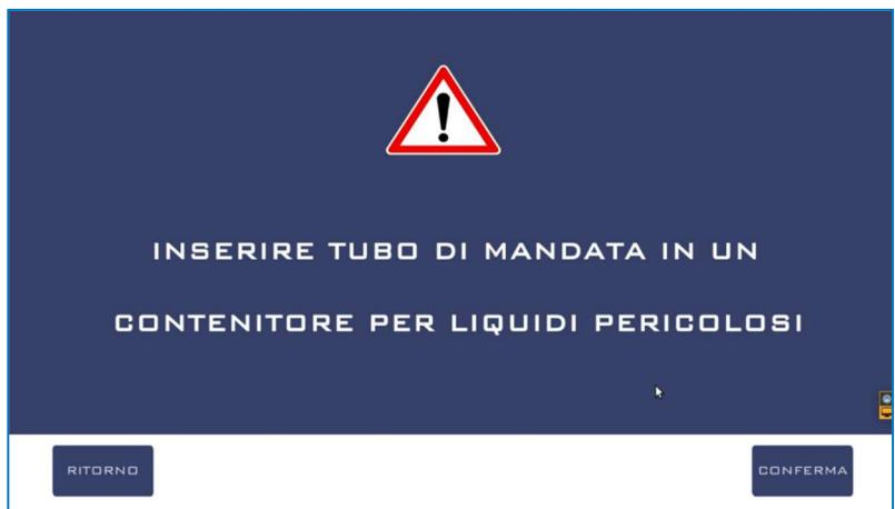
È richiesto all'operatore di inserire il tubo trasparente di mandata dell'acqua in un contenitore idoneo allo stoccaggio del liquido presente nel serbatoio, che si ricorda essere di circa 80 LT.
