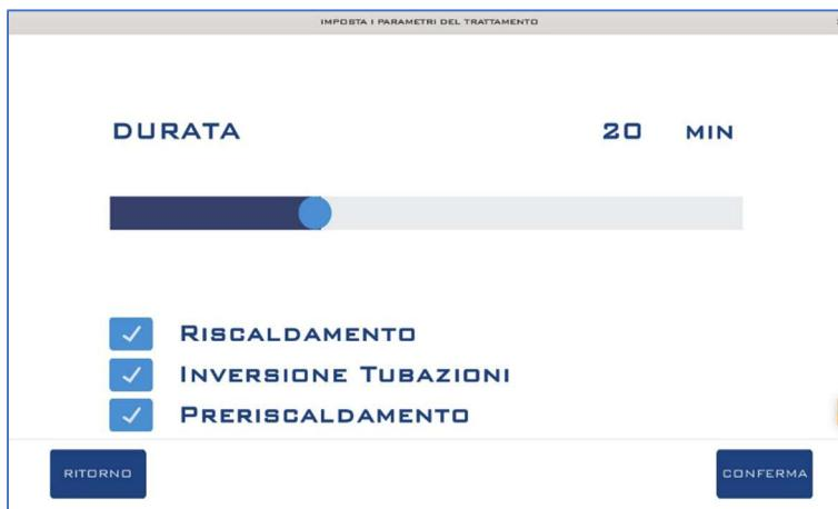
**RISCALDAMENTO:** il lavaggio inizierà con l'acqua a temperatura ambiente per scaldarsi gradualmente durante la lavorazione fino ad arrivare ad una temperatura di circa 45 gradi, in quanto il lavaggio ad acqua calda è più efficace di un lavaggio ad acqua fredda. **Si consiglia di lasciare l'opzione attiva.**
