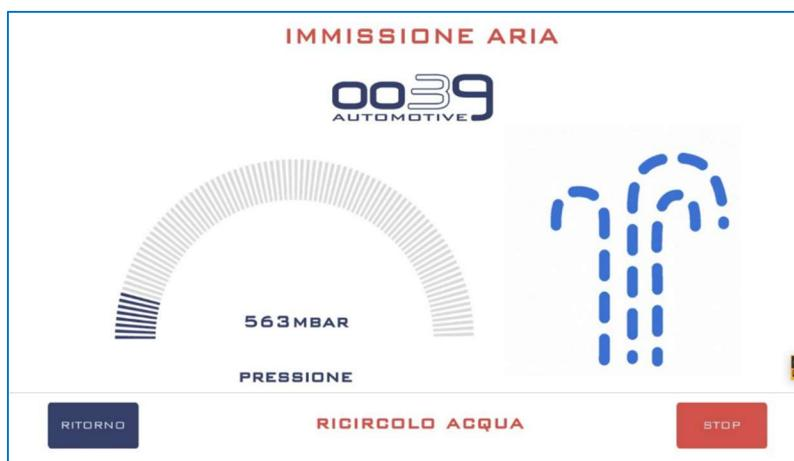
Il programma procederà ad immettere un nuovo quantitativo di aria compressa nel circuito aiutando il deflusso dell'acqua residua presente nel filtro antiparticolo.
