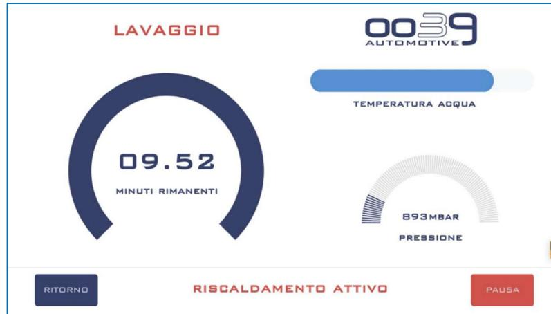
La stazione inizierà ad effettuare il lavaggio del DPF filtrando le impurità, ed indicherà sul display:
