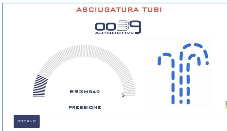
Una volta terminata la fase di asciugatura delle tubazioni il software passa automaticamente alla fase successiva dove sarà richiesto l'intervento dell'operatore.
