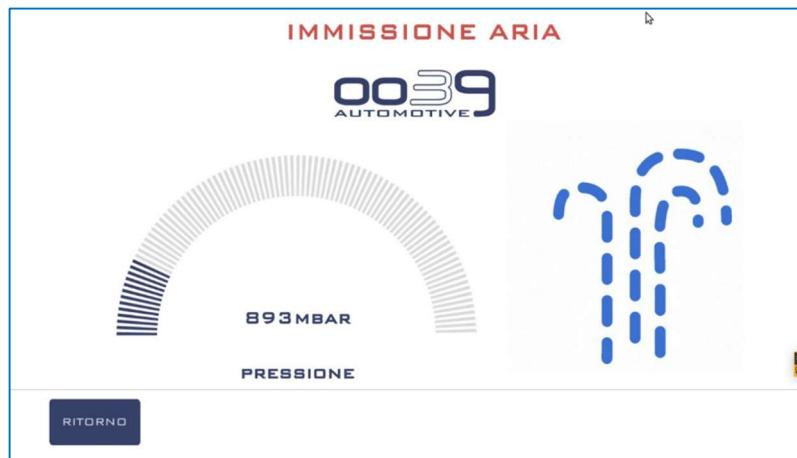
L'immissione di aria compressa nel circuito mediante il serbatoio interno di CLEANFAP, ha lo scopo di far fuoriuscire l'acqua presente nelle tubazioni e buona parte del quantitativo di liquido presente all'interno del filtro antiparticolato.
