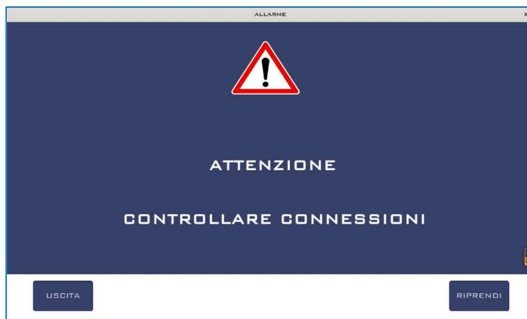
Durante la pulizia del FAP/DPF, in caso di anomalie alla pressione dell'impianto, la pompa viene arrestata dopo 1 secondo. Questo messaggio potrebbe verificarsi anche senza la presenza di sintomi esterni, ciò potrebbe essere dovuto al riempimento lento del FAP/DPF che provocano un allarme al sistema. Basterà premere il pulsante RIPRENDI.
