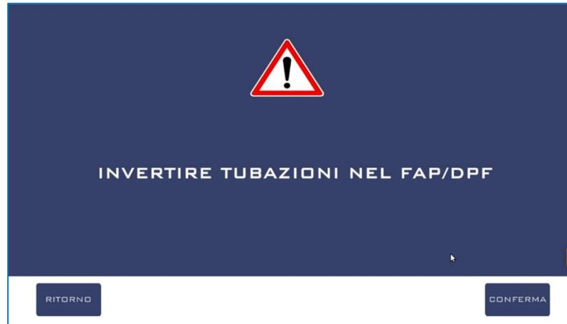
E' richiesto all'operatore di invertire il flusso del liquido all'interno del FAP/DPF. Dove è possibile si può procedere all'inversione delle tubazioni lasciando fermo il filtro anti particolato. Quando invece la lunghezza delle tubazioni non lo permette sarà necessario ruotare il filtro sul pianale di cleanFAP.
