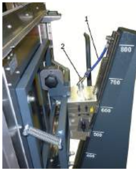
Fig. 11: Fune di sicurezza montata
