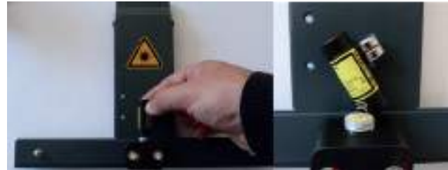
Fig. 16: Sostituzione delle batterie
