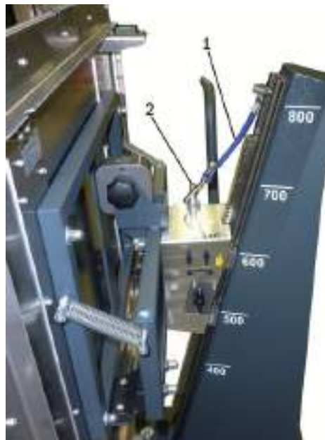
Fig. 5: Fune di sicurezza montata
